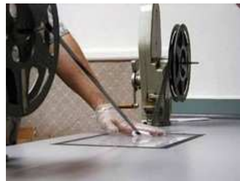
tourner lentement la manivelle de droite en laissant un plus grand bout de film du côté de la bobine réceptrice
